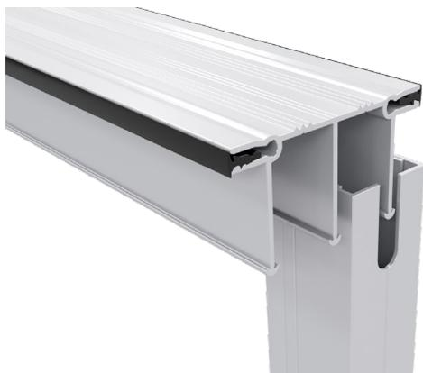
Les caractéristiques de sécurité du système ont été prises en compte dans le verrouillage et la conception des panneaux de verre. À la fin de l'installation, les embouts de panneaux, faciles à fixer, complètent les éléments vitrés. Ils se calent dans des rails de guidage de forme spéciale, empêchant le panneau de verre de tomber, même si les structures environnantes subissent des modifications. Il est impossible de soulever les éléments vitrés des rails sans retirer les embouts.
